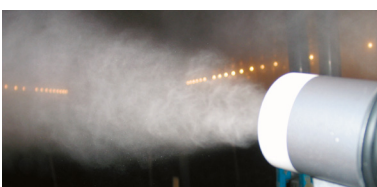
Chorro de niebla fría, cabeza pulverizadora de IGEBA
