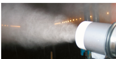
Kaltnebelstrahl, IGEBA ULV-Aerosol Sprühkopf
